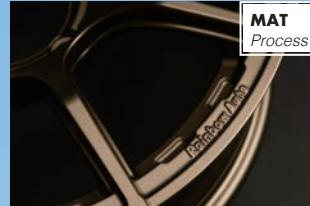
リム部分の製造方法。ENKEI 独自のリム成形技術。铸造ホイールにも匹敵する優れた材料強度を実現。铸造で生成したリムをローラーで引き伸ばしてリム全体を形成。それによって薄肉化で大幅な軽量化を達成。同時に金属密度を高めて铸造ホイールの様に剛性向上。
